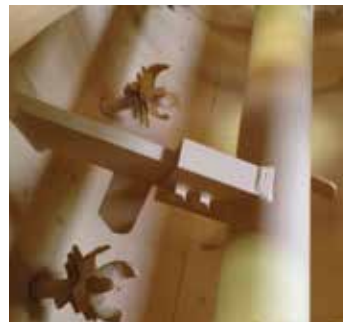
Austauschbare Verschleißschutz-Mischkammerauskleidung
