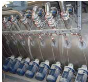
Messerköpfe, Flüssigkeitszugabe, Doppelmantel
