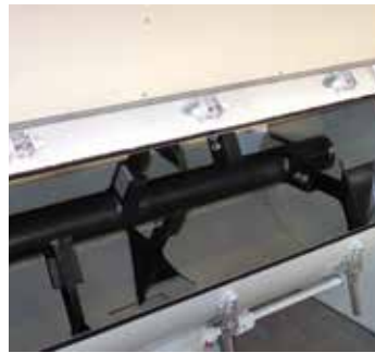
Kammerauskleidung aus Teflon®
